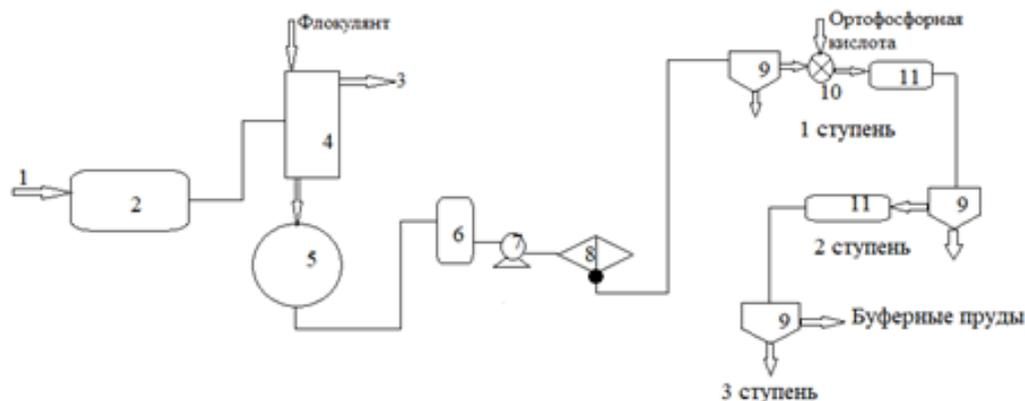
Рис. 2. Модернизированная система очистки сточных вод предприятия «Виразж»:
